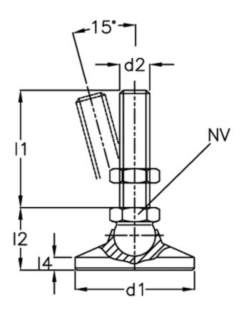
d1 = 50 Static load = 23 d2 = M10 Weight in (g) = 222 l1 = 80 l2 = l3 = 29.5 l4 = -
